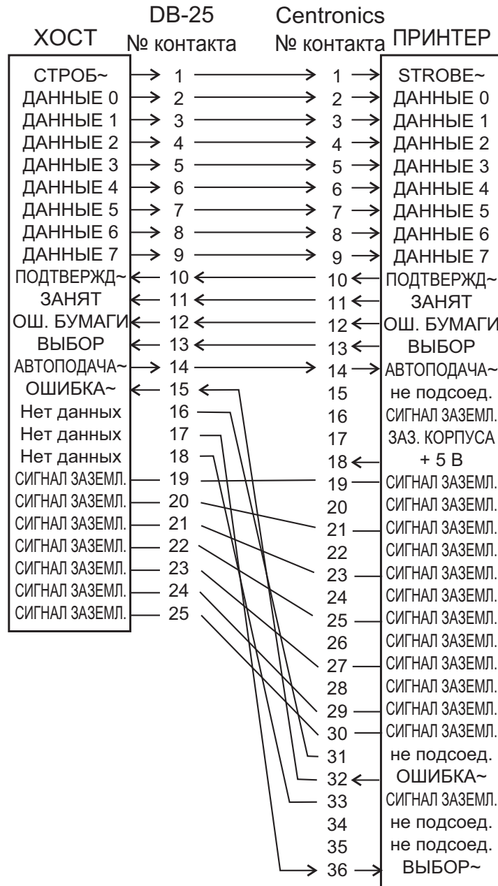
Кабель с разъемами DB-25 и Centronics
